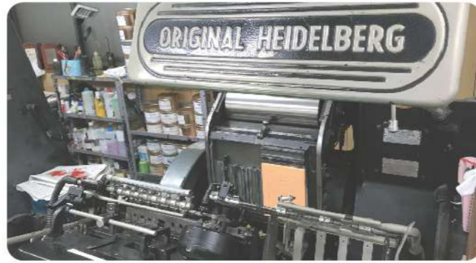
人気の万能機プラテン。独特の風合いを持つ凸版印刷、型抜き加工、スジ入れ、ミシン入れ、ナンバー入れなど様々な加工も可能
